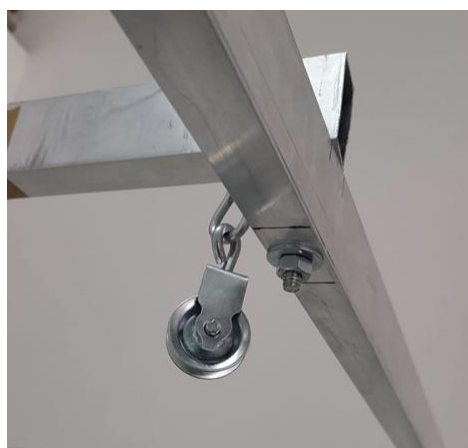
Figura 8: Colocación de roldana
