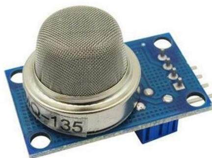
Figura 2: Sensor de calidad de aire MQ-135. Fuente: Ficha técnica.
