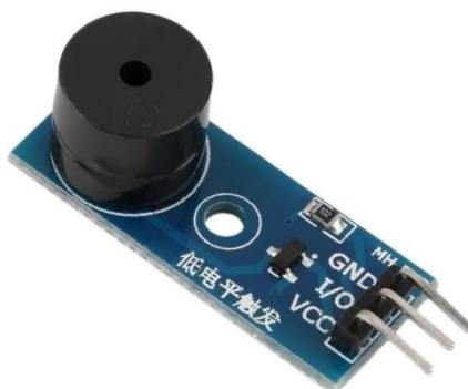
Figura 11: Módulo buzzer activo. Fuente: Ficha técnica del módulo proveída por el fabricante.
