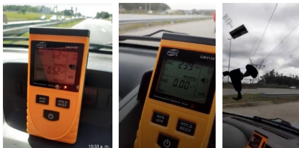
Figura 11: Equipo Benetech sobre vehículo, testeando valores de campo. Fuente Propia.
