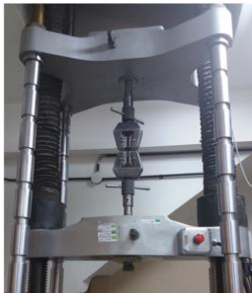
Figura 9: Módulo de tracción TINIUS OLSEN para probetas tipo V.
