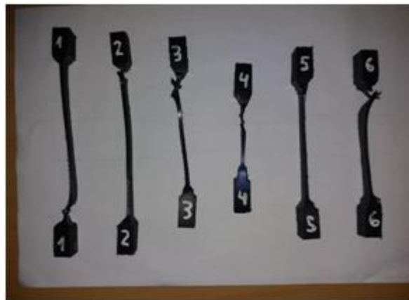
Figura 13: Probetas tipo V ensayadas hasta rotura.
