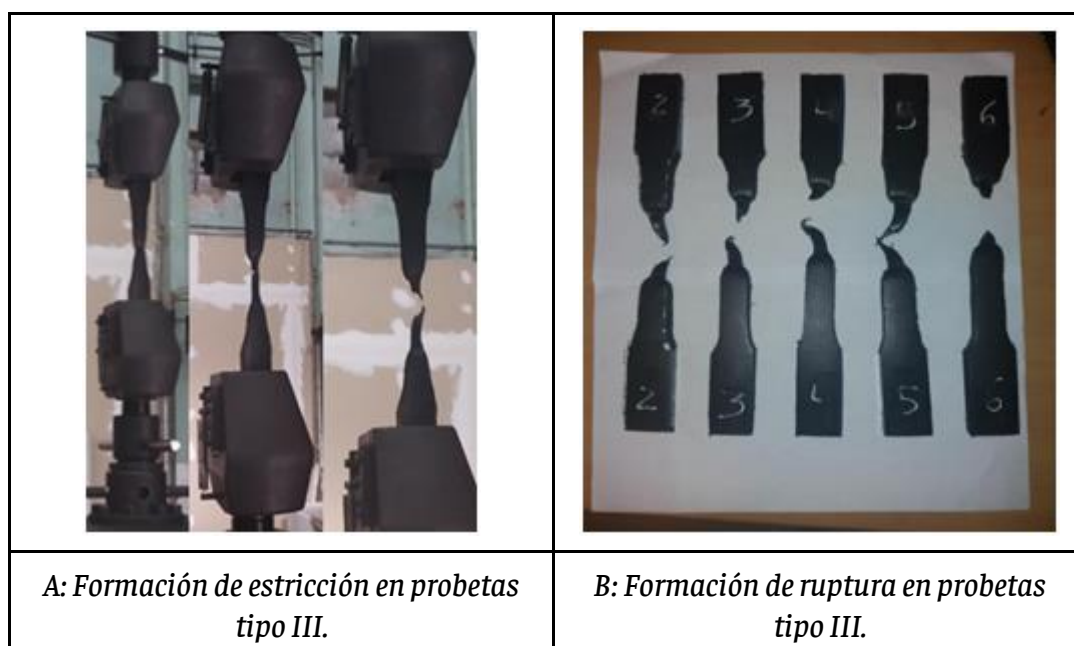
Figura 11: Formación de estricción y rotura en probetas tipo III.
