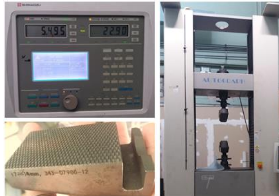
Figura 8: SHIMADZU AG-100kNG para ensayo de probetas tipo III.
