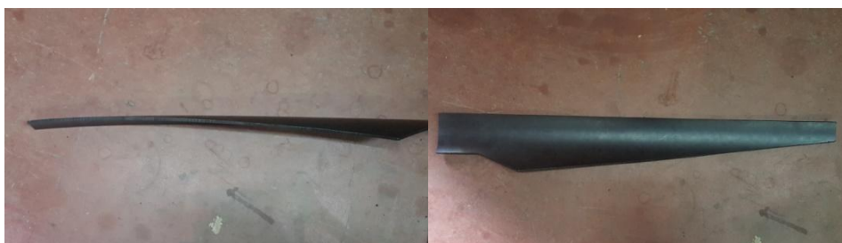
Figura 6: Vista lateral y frontal del modelo de perfil de álabes del aerogenerador social empleado.
