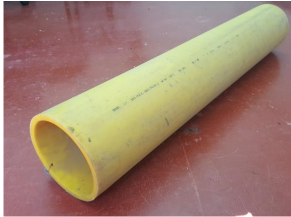
Figura 8: Tubo utilizado de PEAD 100-As Received.
