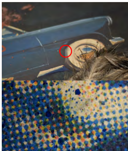
Figura 12. Detalle del auto: aumento de impresión de fotolitografía de medio tono.
